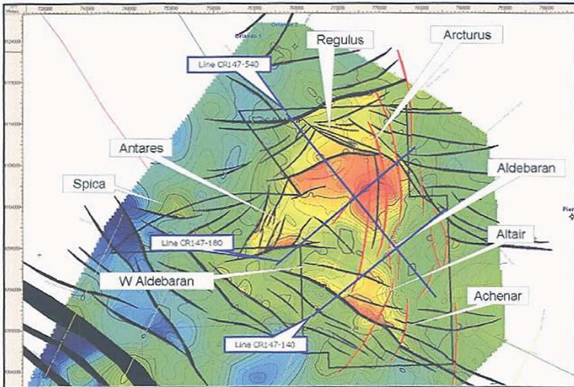
Figura 9 – Mappa in profondita' del top della Formazione Abiod
